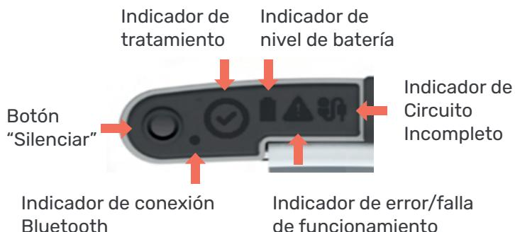
Los indicadores Nivel de batería, Error/Falla de funcionamiento y Circuito Incompleto también tienen una vibración y un zumbido audible en caso de que los íconos no sean visibles.
